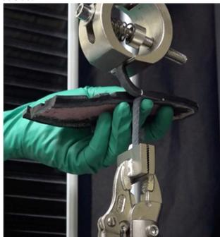
*Nota.* Ítem de ensayo en la máquina universal mostrando la disposición para la prueba de resistencia a la unión corte-suela.
